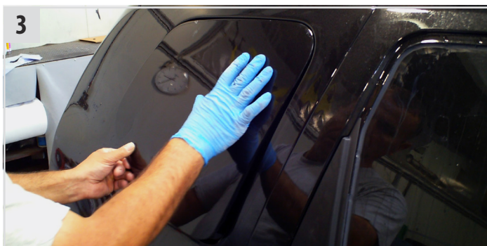
Trykk panelet / sideruten på plass. For å hindre sig kan panelet / ruten holdes på plass med et par lengder duct-tape i ca. 15 minutter.
