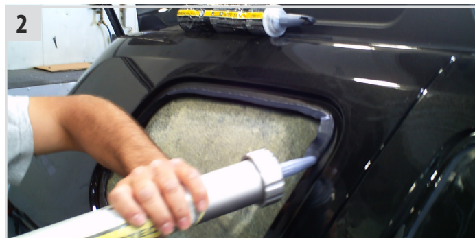
Påfør SafeSeal IQ ved hjelp av V-skåret nozzle
